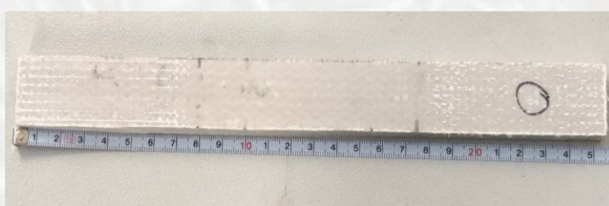
Рисунок 2 – Не доведенный до разрушения из-за проскальзывания образец
