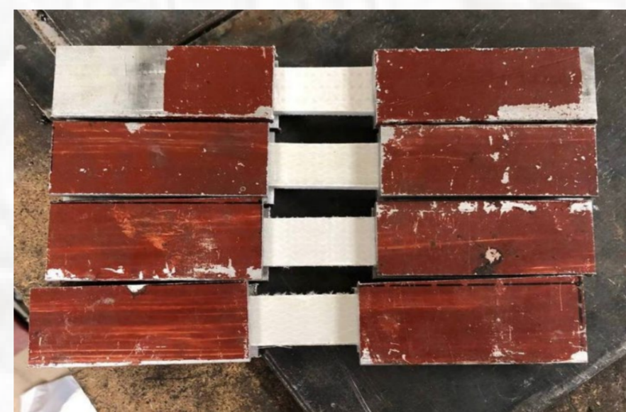
Рисунок 4 - Образцы с приклеенными алюминиевыми накладками
